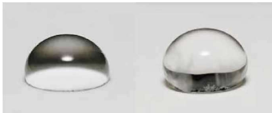
قطره آب در پوشش سیلیکون تمیز (سمت چپ) و در پوشش با لایه آلودگی در سمت راست. علت اثر انتقال خاصیت آبگریزی به لایه آلودگی
