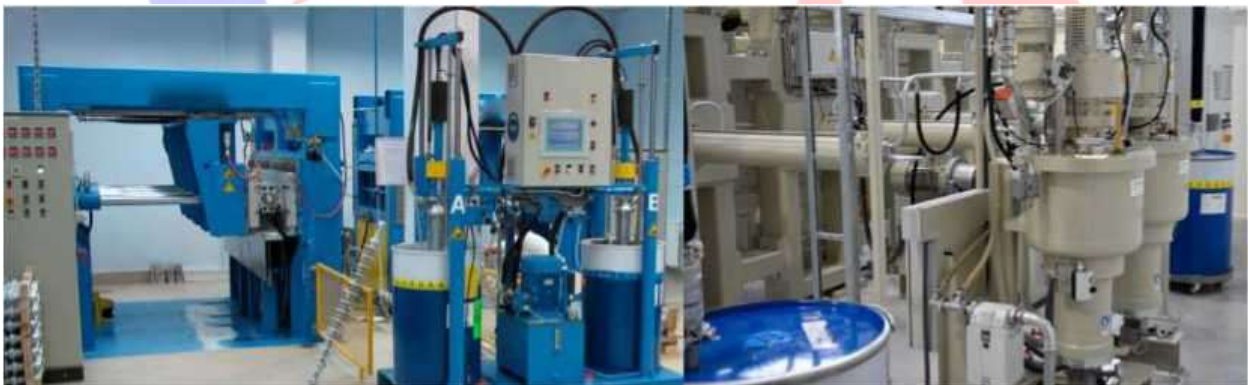
LSR دو جزئی برای تهیه مقره با قالب و دستگاه مخصوص به خود
